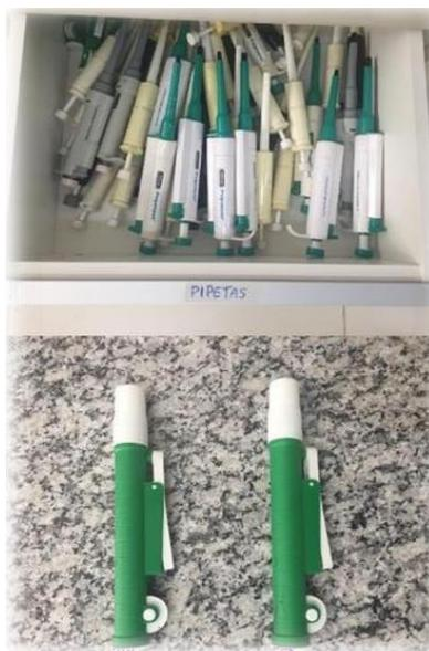
Figura 11: Auxiliar de pipetagem – Laboratório Multifuncional II
