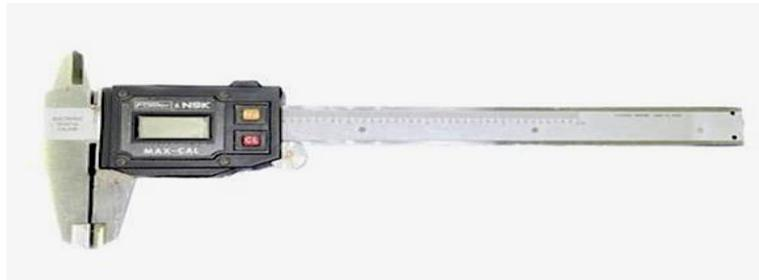
Figura 9. Paquímetro digital.
