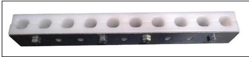
**Figura 1** – Abraçadeira para adaptação dos corpos de prova.
