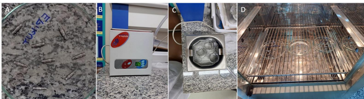
Figura 1 - Limpeza das amostras. Seleção dos implantes (a) seguido pela limpeza em ultrassom (B e C) e posteriormente secos em estufa (D).
