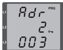
Fig. TCP / IP address, byte 2, value 003
