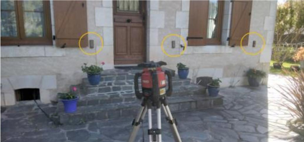
**Figure n°12 : Matériel pour monitoring laser**
