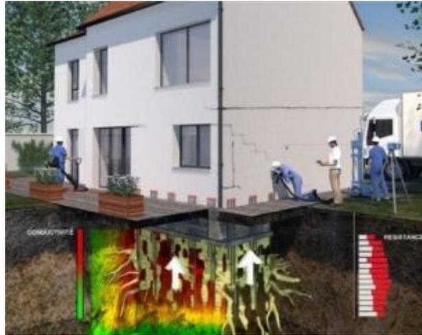
**Figure n°1 : Principe d'injection sous fondation (semelles filantes, massifs isolés)**
