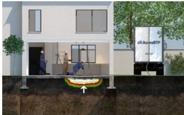
**Figure n°2 : Principe d'injection sous dallage ou radier**
