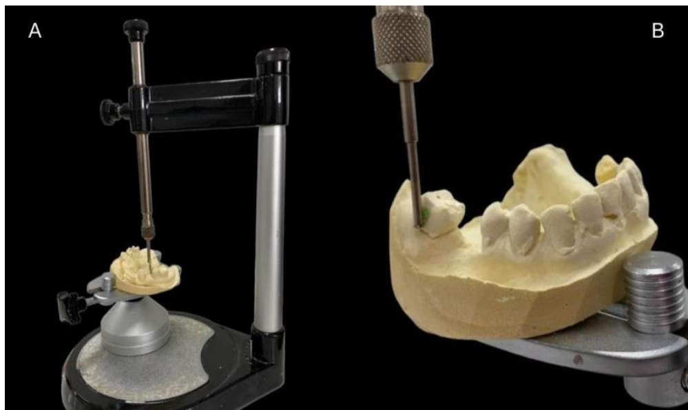
Figura 5- Modelo de estudo no delineador Bioart (A) e Ponta calibradora 0,25mm (B).
