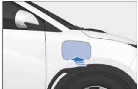
Öffnen Sie die Steckerabdeckung der Ladepistole und die Fahrzeugsteckdose, um sicherzustellen, dass sich am Ende der Ladepistole und der Ladesteckdose kein Hindernis befindet. Für das Laden über Wech-
