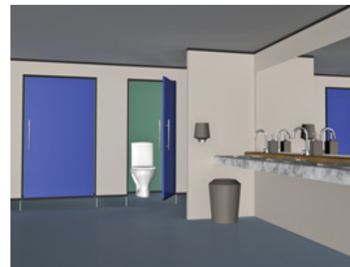
Gangareal i sanitæranlegg med god bredde og gode kontraster mellom gulv og vegg og inventar/utstyr.
