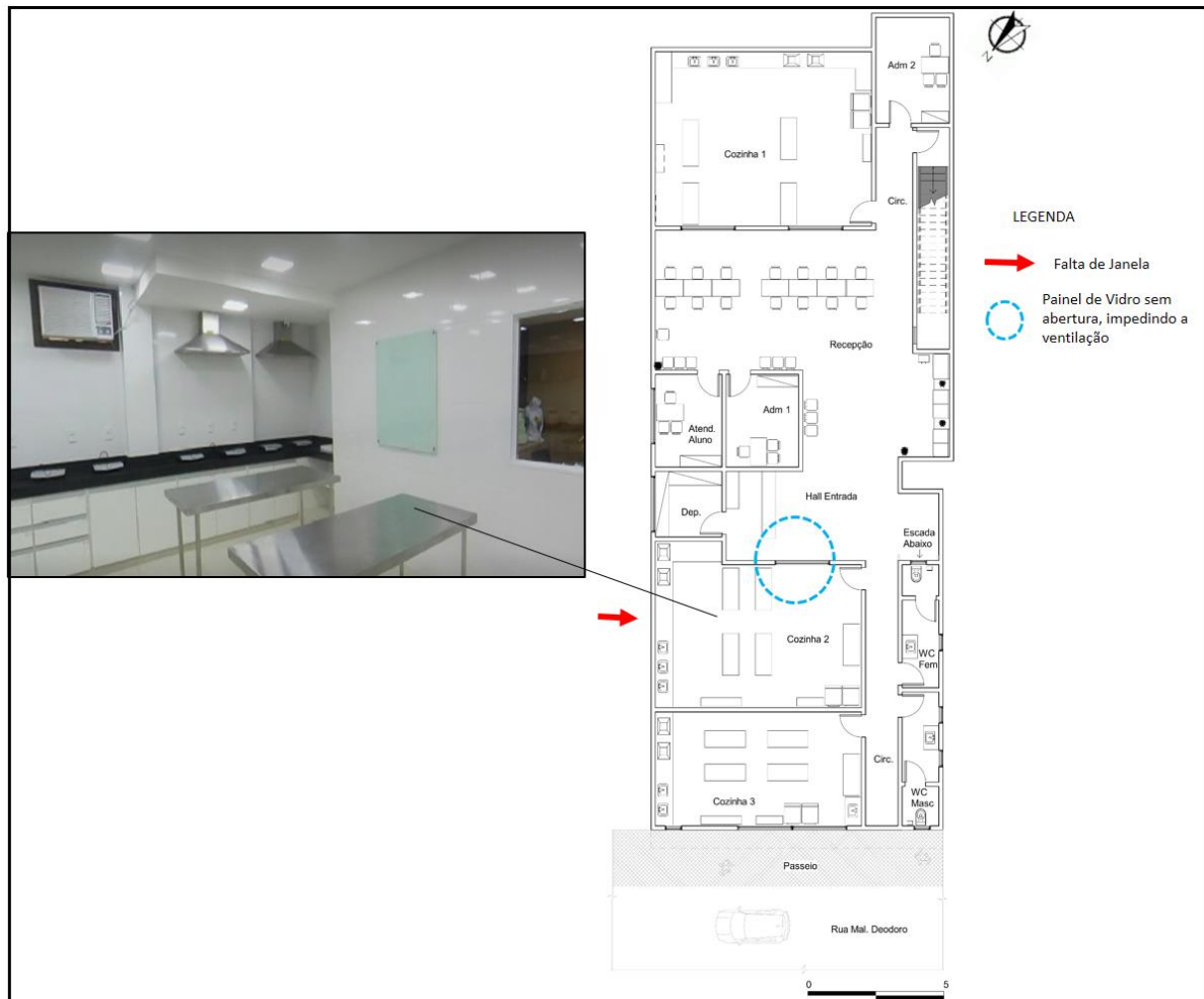
Figure 19-Foto Falta de Janela na cozinha Instituto Gourmet
