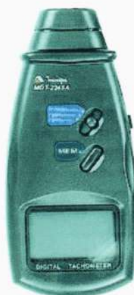
Figura 18: Tacômetro utilizado para medir rotação
