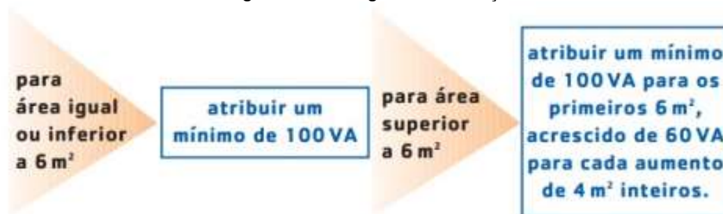
Figura 13 – Carga de iluminação
