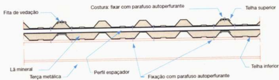
Figura 35: Montagem da Telha Trapezoidal com Lâ Mineral (Fonte: ABCEM, 2009)
