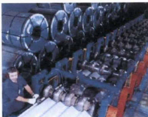
Figura 18: Bobinas de aço ao fundo e perfilação das folhas de aço à frente (Fonte: ABCEM, 2009)
