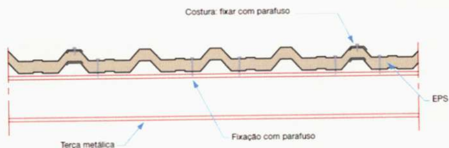
Figura 28: Montagem da telha termoacústica com EPS (Fonte: ABCEM, 2009)
