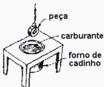
Figura 11: Cementação por banho (Fonte: SENAI-ES – Companhia siderúrgica de Tubarão, 1997)
