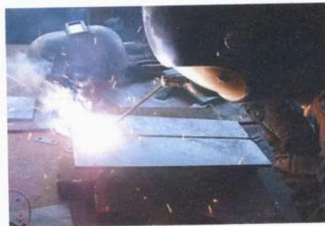
**Figura 27:** Processo de soldagem por eletrodo revestido (Fonte: Acervo pessoal)
