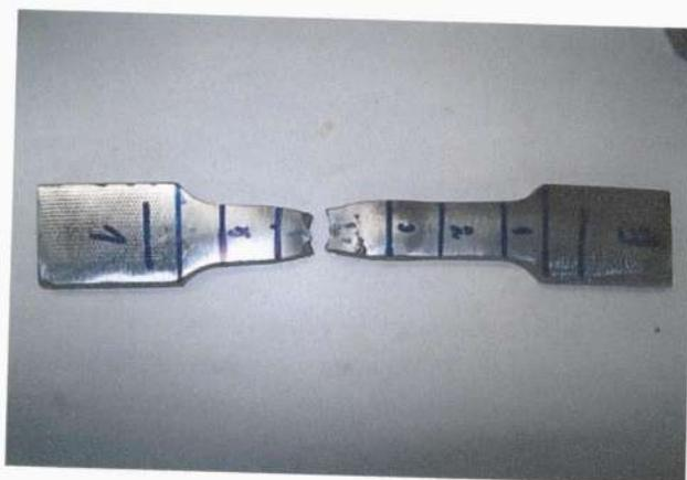
**Figura 38:** Corpo de prova 1 após ensaio (Fonte: Acervo pessoal)
