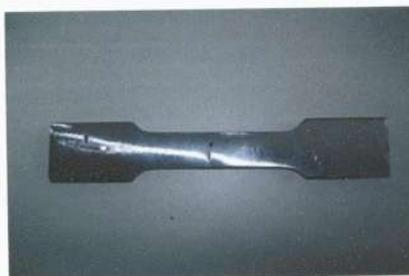
**Figura 30:** Corpo de prova para ensaio de tração (Fonte: Acervo pessoal)
