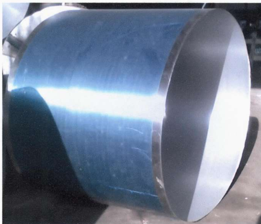
Figura 2: Anel do costado tanque. (Arquivo pessoal).
