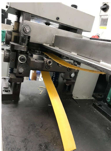
Figura 5 – Aplainamento de amostra de HDPE. Fonte: PRÓPRIO AUTOR (2022).
