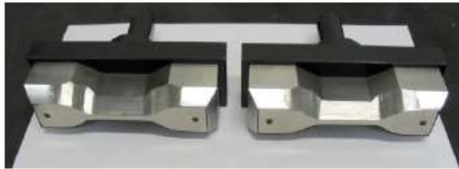
Figura 9 - Dispositivo de corte conforme norma ASTM D638 tipo IV. Fonte: MM Indústria Mecânica Ltda.
