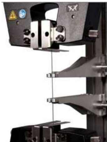
Figura 18 - Ponte fixa e móvel da Máquina Universal de Tração. Fonte: Instron (2021).
