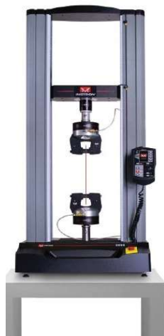
Figura 17 - Máquina Universal de tração. Fonte: Instron (2021).
