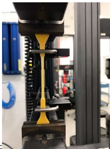
Figura 19 - Corpo de prova de HDPE fixado entre as garras da máquina de tração. Fonte: PRÓPRIO AUTOR (2022)
