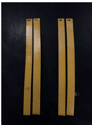
Figura 6 - Amostra aplainada de HDPE. Fonte: PRÓPRIO AUTOR (2022)
