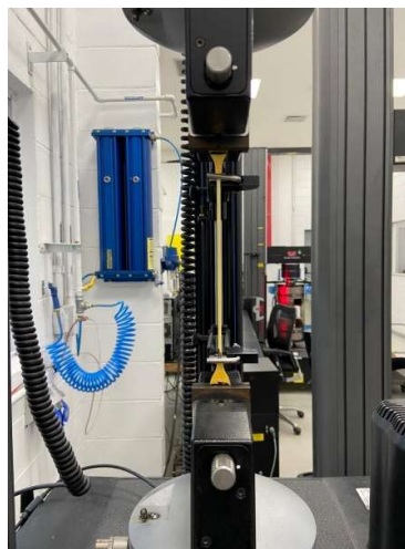
Figura 22 - Empescoçamento corpo de prova de HDPE. Fonte: PRÓPRIO AUTOR (2022)
