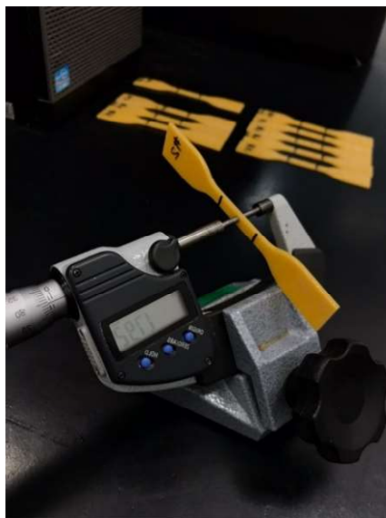
Figura 15 – Medição de espessura do HDPE. Fonte: PRÓPRIO AUTOR (2022).
