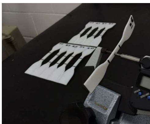
Figura 16 — Medição de espessura do PVDF. Fonte PRÓPRIO AUTOR (2022).
