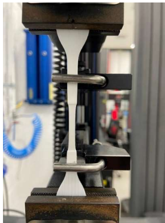
Figura 28 - Deformação plástica do corpo de prova de PVDF. Fonte: PRÓPRIO AUTOR (2022).
