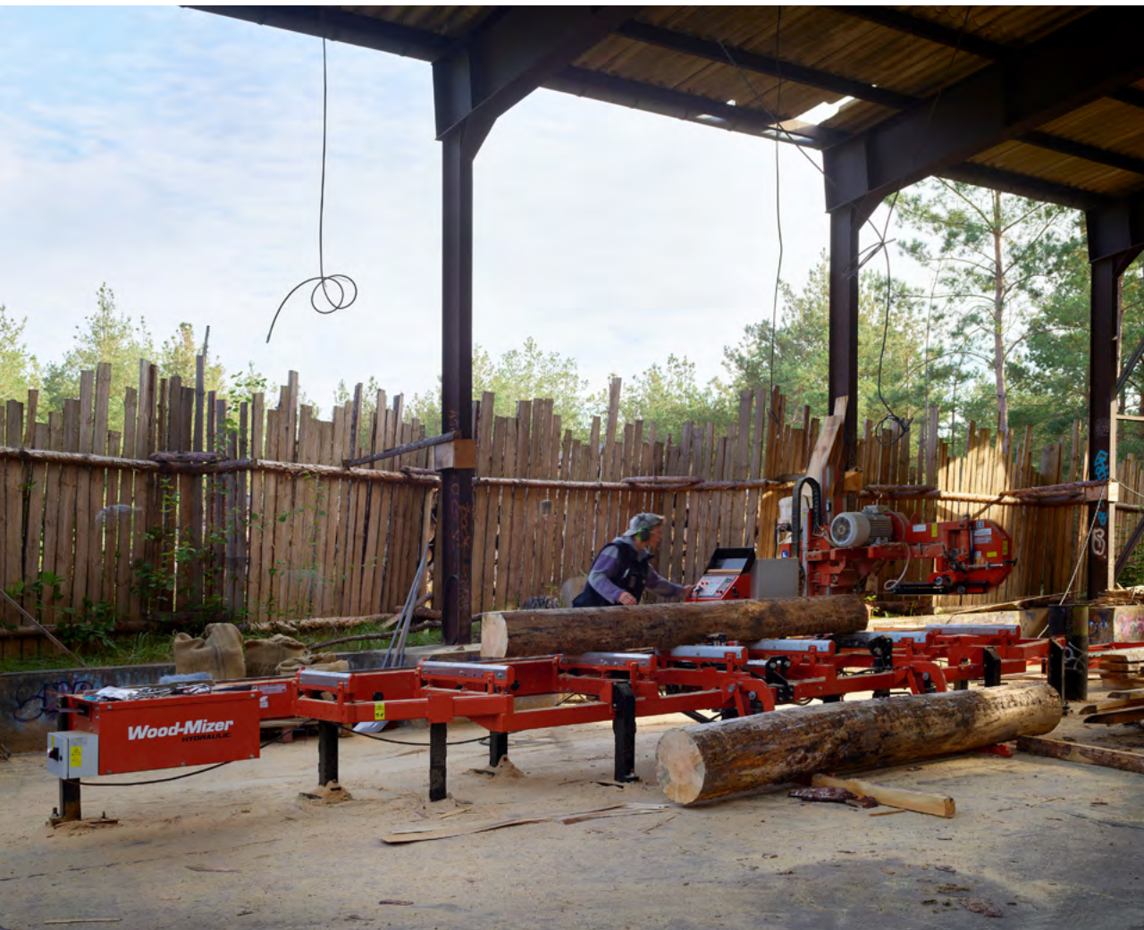
Abb. 2: Verarbeitung von Kiefernstämmen im Sägewerk der Waldwirtschafterei auf dem Alten Postgelände
