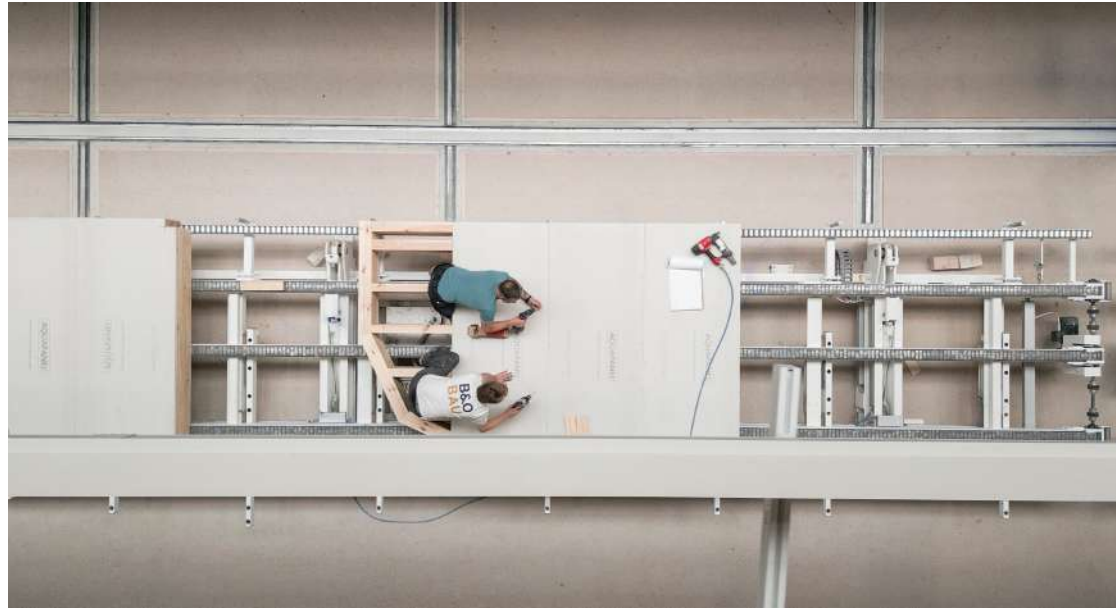
↑ Abb. 35: Werkseitige Vorfertigung der Holz-Bodenplattenelemente auf dem Montagetisch im B&O-Werk in Frankfurt/Oder
