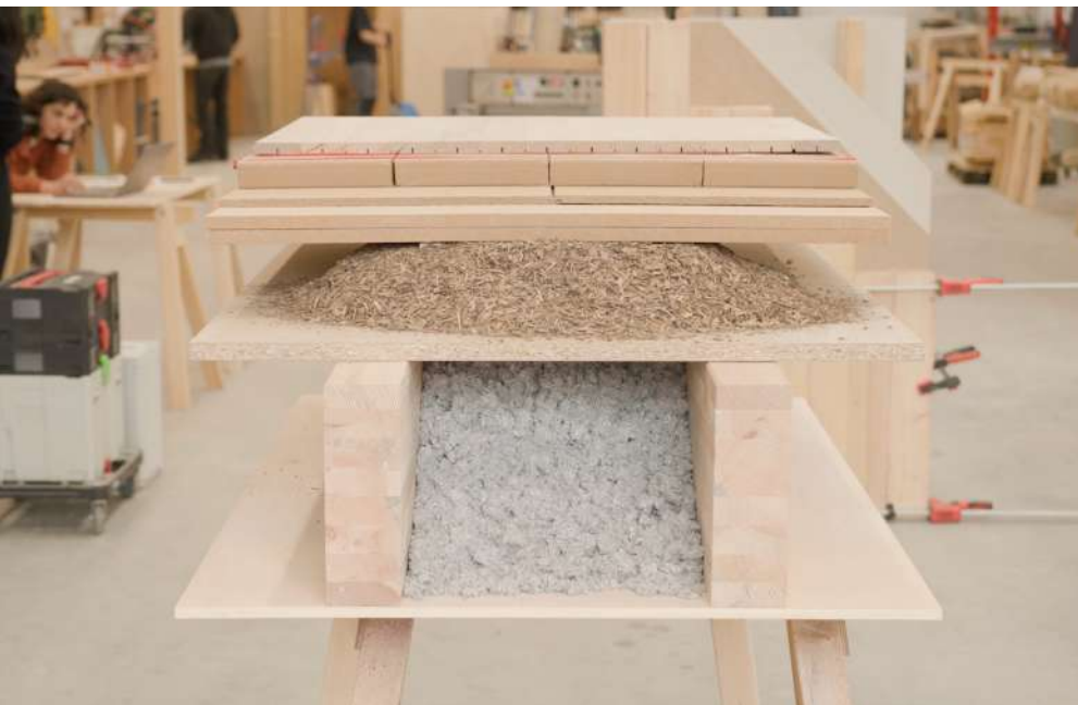
←↓ Abb. 33, 34: Herstellung Demonstrator Holz-Bodenplatte Fotos: Fabian Wolf
