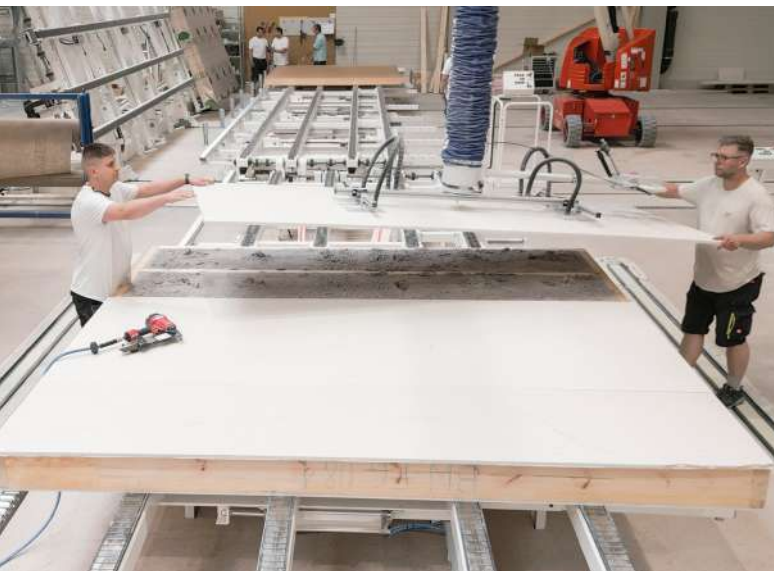
↑ Abb. 62: Produktionshalle für die serielle Vorfertigung der Holz-Gebäudeabschlusswand im B&O-Werk in Frankfurt/Oder
