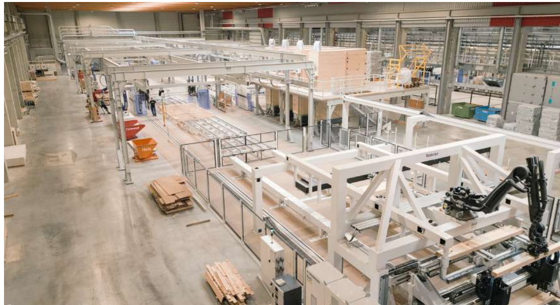
↑ Abb. 62: Produktionshalle für die serielle Vorfertigung der Holz-Gebäudeabschlusswand im B&O-Werk in Frankfurt/Oder
