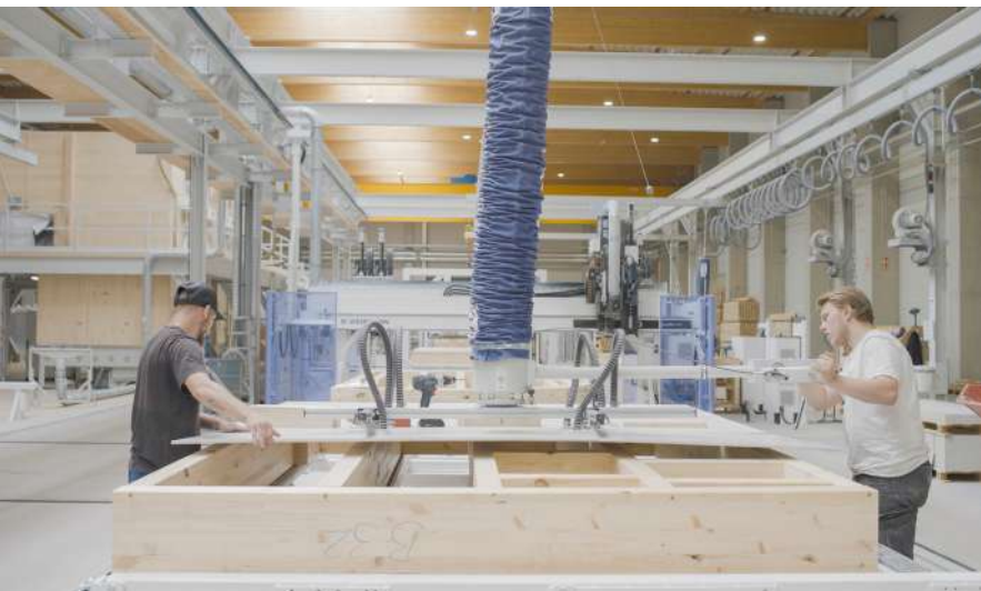
↑ Abb. 35: Werkseitige Vorfertigung der Holz-Bodenplattenelemente auf dem Montagetisch im B&O-Werk in Frankfurt/Oder
