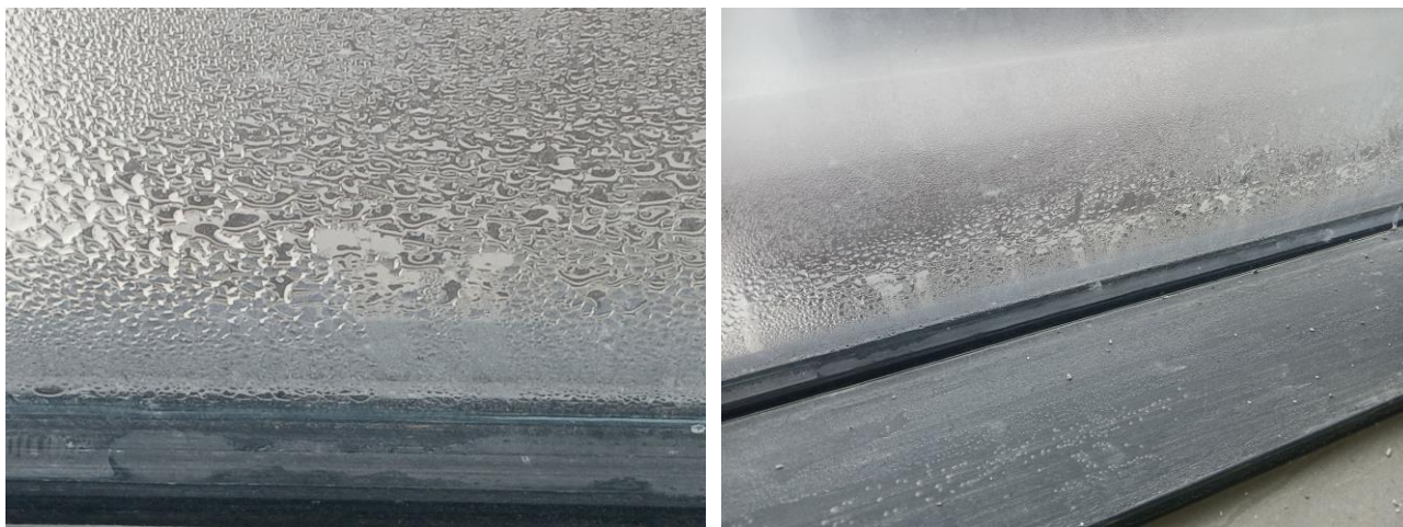
Poređenje kondenzacije i zamagljenja unutar međuprostora. Samo pojava u hermetički zatvorenom međuprostoru može ukazivati na gubitak zaptivenosti. Izvor: arhiva Konkav-konveks doo
