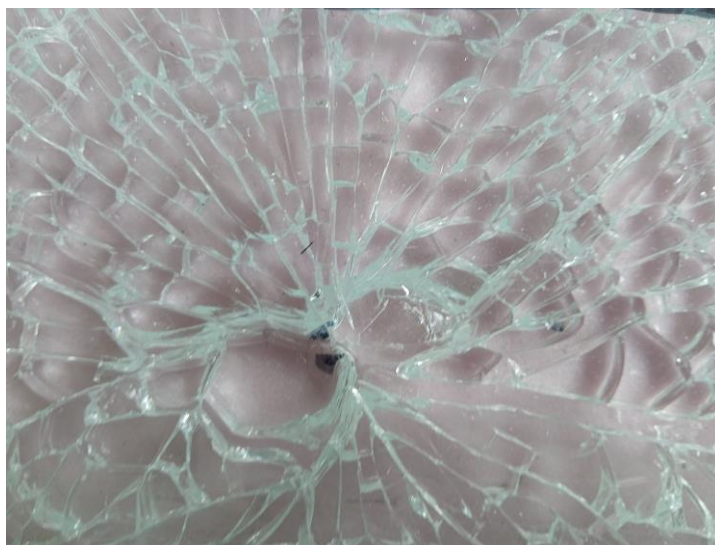
Prikaz loma kaljenog stakla izazvan inkluzijom NiS. Oblik fragmenata i mesto inicijacije analiziraju se u okviru tehničke procene; ilustracija nije dijagnostički kriterijum. Izvor: arhiva Konkav-konveks doo
