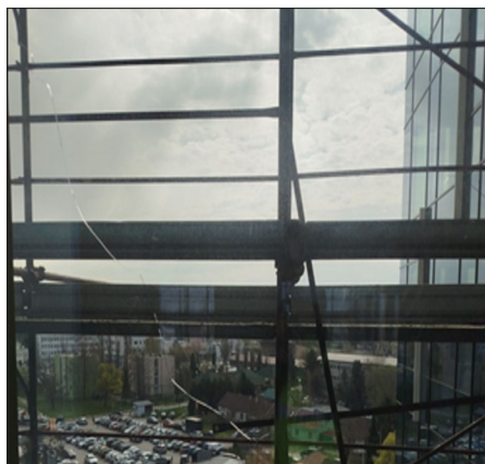
Primer termičkog loma koji se često inicira na ivici usled temperaturnog gradijenta. Konačan uzrok se utvrđuje pregledom položaja, ivice i uslova eksploatacije. Izvor: arhiva Konkav-konveks doo
