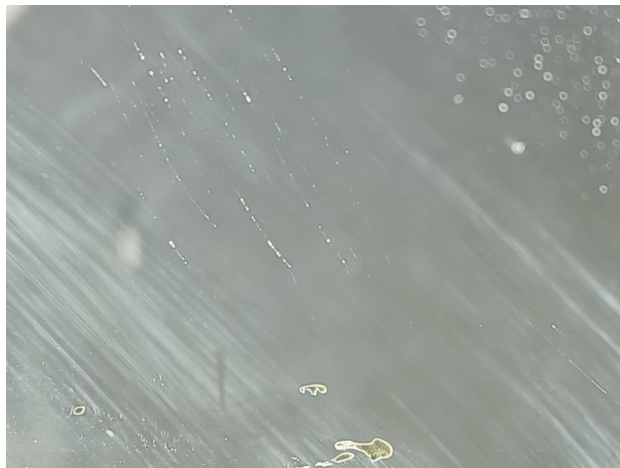
Primer trajnog oštećenja stakla izazvanog neadekvatnim čišćenjem. Takva oštećenja nastaju nakon proizvodnje i ne predstavljaju odgovornost proizvođača. Izvor: arhiva Konkav-konveks doo
