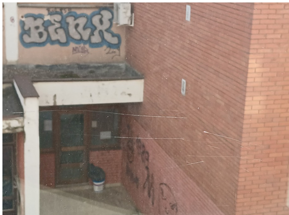
Primer trajnog oštećenja stakla izazvanog neadekvatnim čišćenjem. Takva oštećenja nastaju nakon proizvodnje i ne predstavljaju odgovornost proizvođača. Izvor: arhiva Konkav-konveks doo
