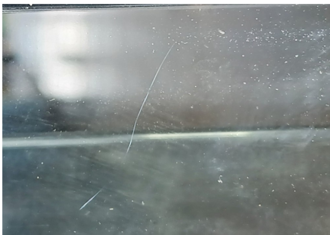
Prikaz trajnih oštećenja nastalih varnicama, metalnim česticama i neadekvatnom manipulacijom. Takva oštećenja nastaju nakon proizvodnje i zahtevaju preventivnu zaštitu na gradilištu. Izvor: Slika 1 arhiva Konkav-konveks; slika 2 https://glassrenu.com/
