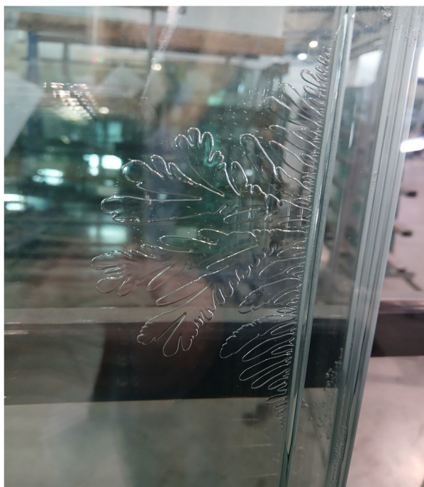
Prikaz pojave mehurića i odvajanja uz ivicu laminiranog stakla. Uzrok može biti procesni ili posledica vlage, UV zračenja, otvorene ivice i nekompatibilnih materijala. Izvor: arhiva Konkav-konveks doo
