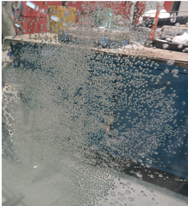
Prikaz pojave mehurića i odvajanja uz ivicu laminiranog stakla. Uzrok može biti procesni ili posledica vlage, UV zračenja, otvorene ivice i nekompatibilnih materijala. Izvor: arhiva Konkav-konveks doo
