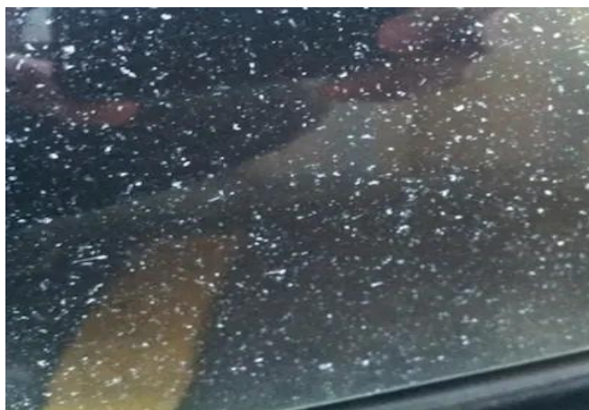
Prikaz trajnih oštećenja nastalih varnicama, metalnim česticama i neadekvatnom manipulacijom. Takva oštećenja nastaju nakon proizvodnje i zahtevaju preventivnu zaštitu na gradilištu. Izvor: Slika 1 arhiva Konkav-konveks; slika 2 https://glassrenu.com/
