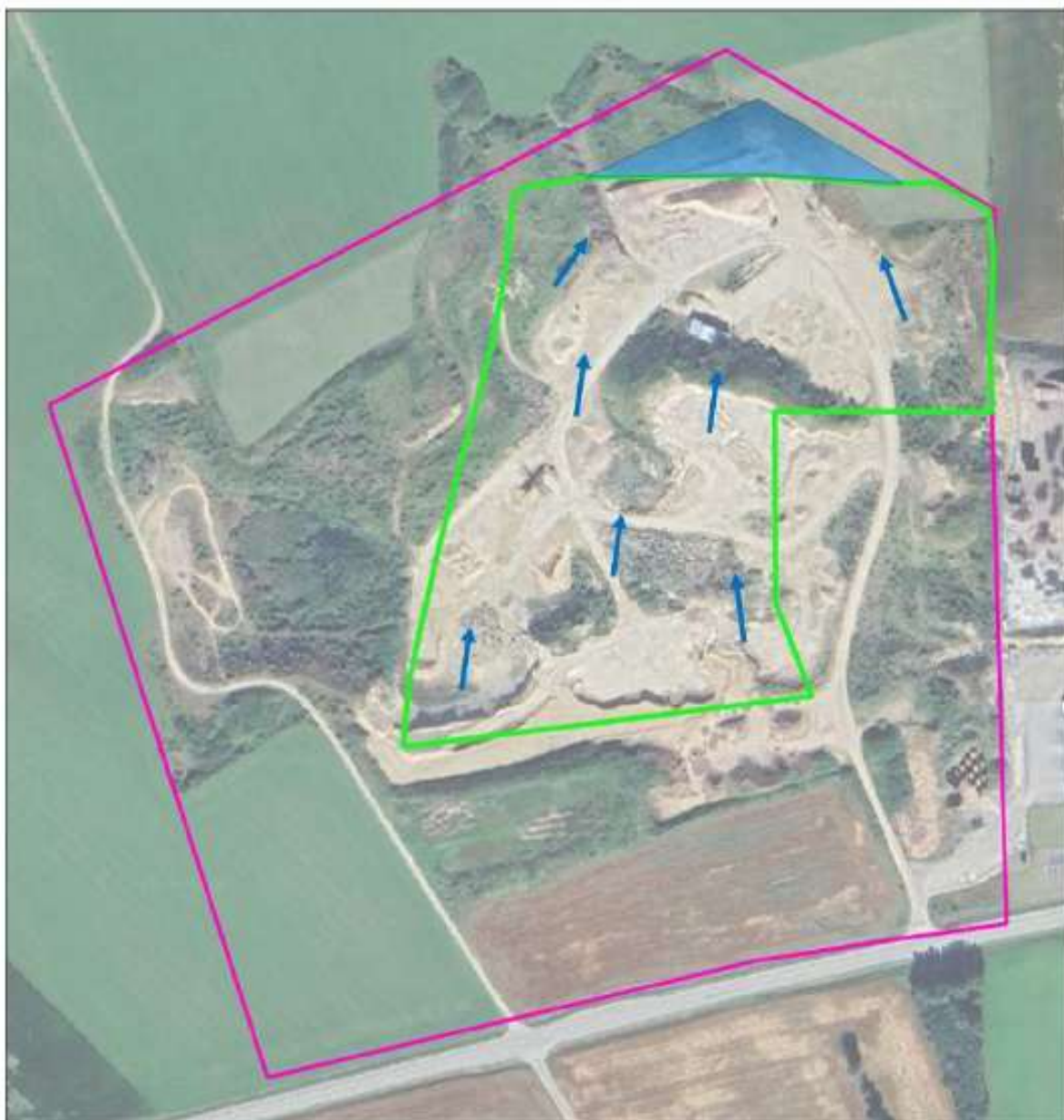
Figur 16. Illustration av hantering av avrinnande dagvatten från det planerade utfyllnadsområdet, blå pilar visar ytavrinningsriktning. Placering av planerat dammsystem visas med transparent blå färg. Planerat verksamhets- och utfyllnadsområde är markerat i magenta respektive grönt. Kartkälla: Google 2026.
