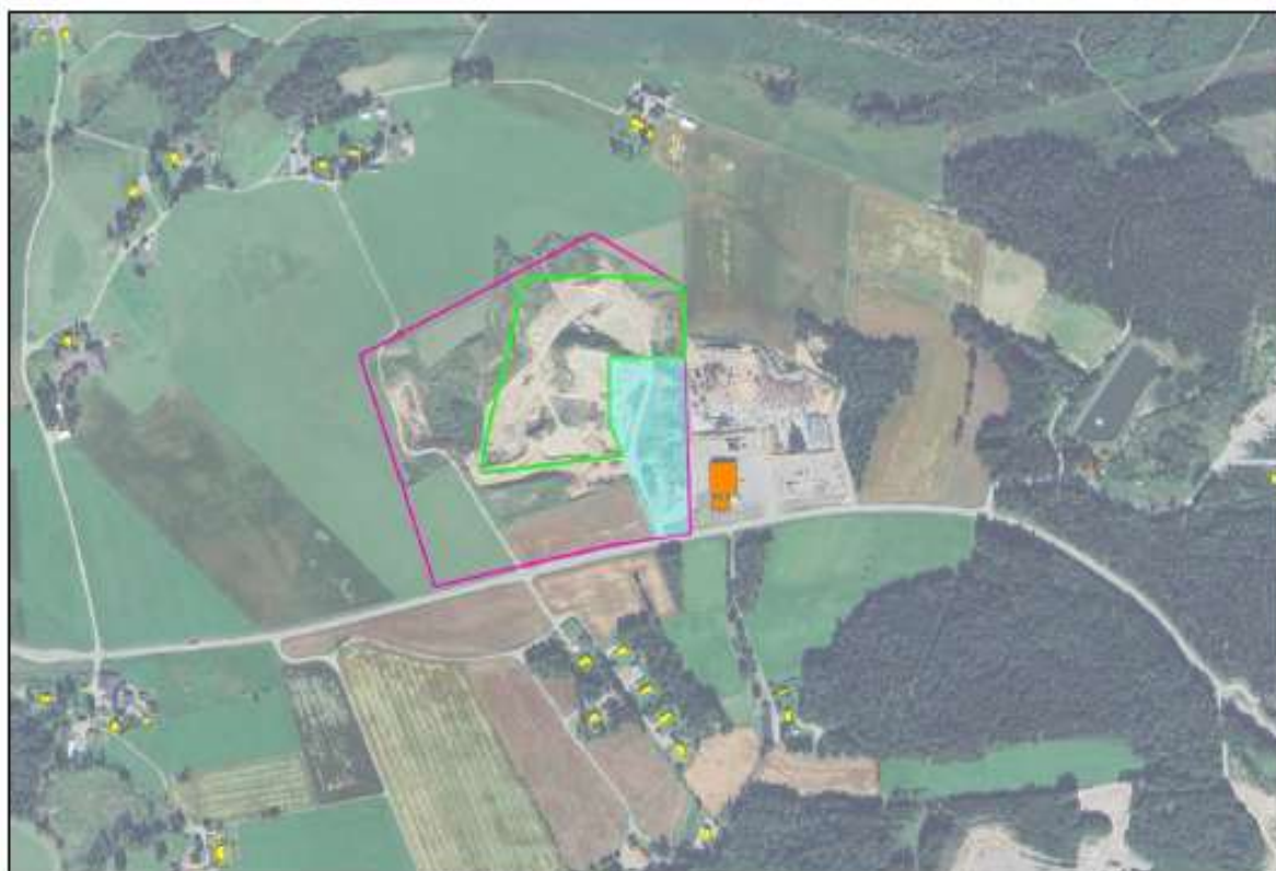
Figur 3. Bostadshus i gult och verksamhetsbyggnad i orange. Pågående utfyllnadsområde för industriverksamhet visas med transparent turkos. Planerat verksamhets- och utfyllnadsområde är markerat i magenta respektive grönt. Kartkällor: Google 2026/Lantmäteriet 2026.
