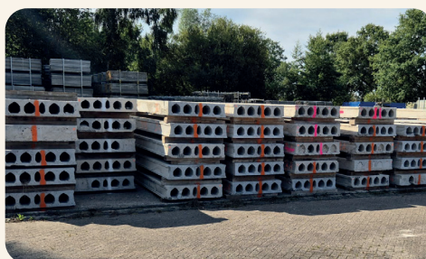
Hergebruikte geïsoleerde kanaalplaatvloeren
