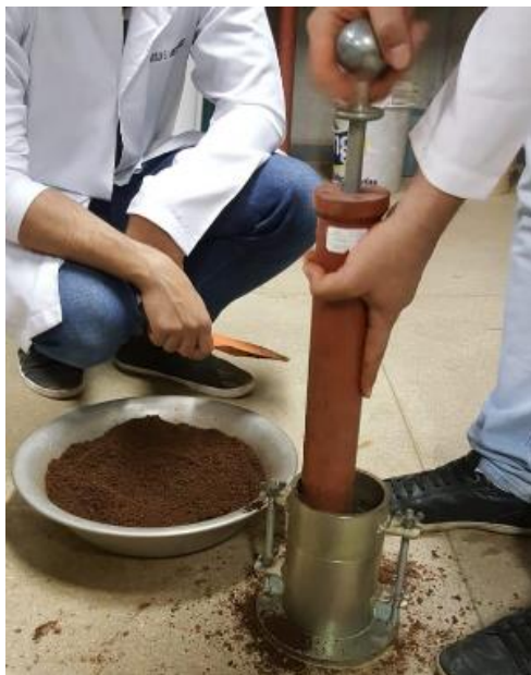
Figura 1 - Compactação do corpo de Prova com o Soquete.
