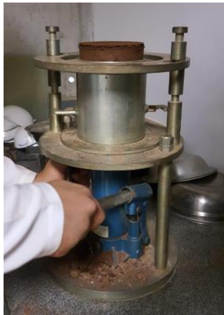
Figura 2- Retirada do corpo de Prova com o auxílio do extrator
