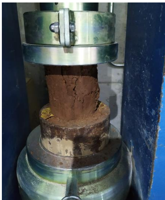
Figura 4 - Ruptura do Corpo de Prova 3
