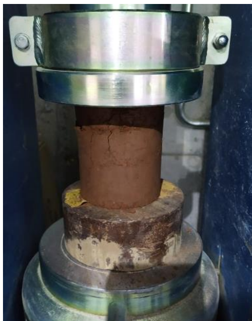
Figura 3 – Ruptura do Corpo de Prova 1
