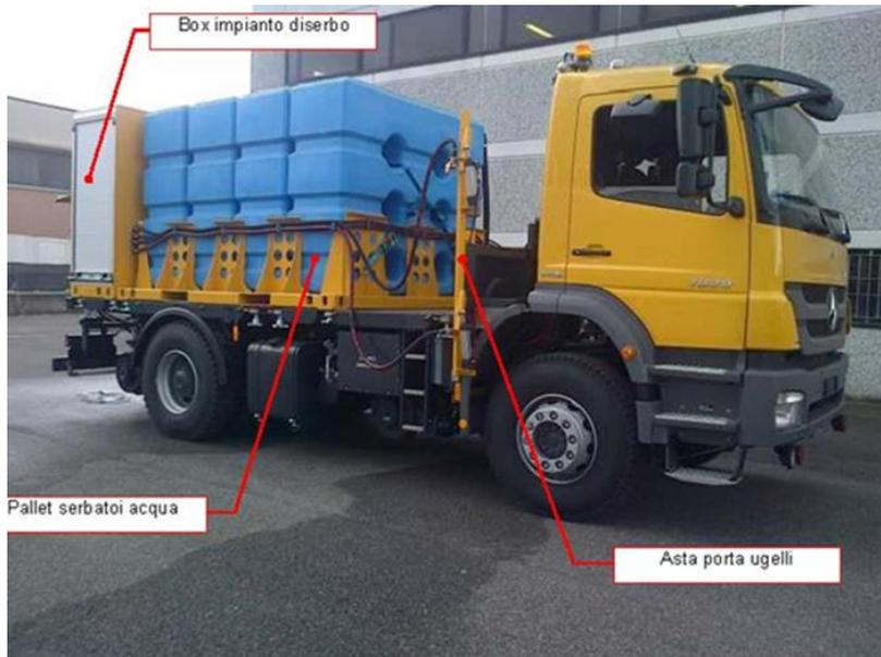
Questa particolare attrezzatura polifunzionale viene utilizzata per eseguire diverse operazioni mediante la sostituzione dell'intero pianale con allestimento per raccolta e cippatura o allestimento con impianto di diserbo. Inoltre, il mezzo può viaggiare sia su strada che sui binari ferroviari grazie ad un sistema pneumatico che gli consente di posizionarsi sulle rotaie mediante ruote ferroviarie.
