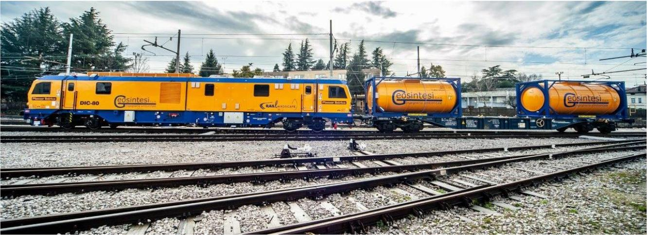
Mezzo ferroviario dotato di un sistema di monitoraggio e riconoscimento della vegetazione infestante e di un innovativo sistema di diserbo computerizzato in grado di effettuare i trattamenti in maniera selettiva permettendo una sensibile riduzione dell'uso di fitofarmaci ed acqua.
