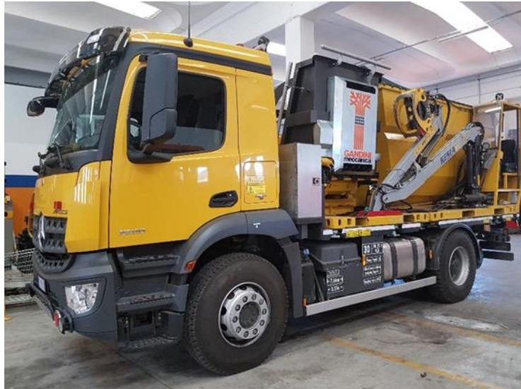
Mezzo bimodale strada rotaia polifunzionale con pianale intercambiabile per attività di diserbo o sminuzzamento del legname di risulta. Il mezzo, quando allestito con impianto di diserbo è dotato di un sistema di monitoraggio e riconoscimento della vegetazione infestante e di un innovativo sistema di diserbo computerizzato in grado di effettuare i trattamenti in maniera selettiva permettendo una sensibile riduzione dell'uso di fitofarmaci ed acqua.
