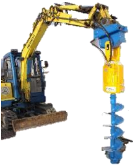
1130 ERDBOHRER Ø 30cm, Bohrtiefe bis 1m für Bagger 2,7t und 3,5t pro Tag 55,-- € (65,45 €)
