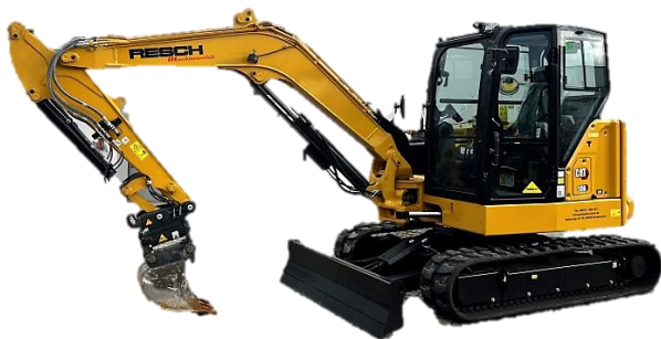
Bagger 6,6t Powertilt und Hydraulischem Schnellwechsler
