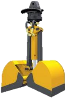
1110 HYDRAULIKGREIFER MS03 60cm für Bagger 2,7t / 3,5t Hydraulisch drehbar 80kg, Greifweite max.110cm Greiferinhalt 55l pro Tag 28,-- € (33,32 €)
