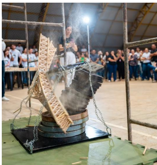
Figura 7 – Momento exato em que a ponte entra em colapso
