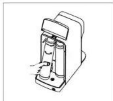
Soulevez chaque cartouche de filtre vers vous et tournez-la dans le sens inverse des aiguilles d'une montre pour la retirer. Insérez la nouvelle cartouche de filtre dans la bonne position et tournez-la dans le sens des aiguilles d'une montre jusqu'à entendre un clic. Remarque : vous pouvez éliminer en toute sécurité les cartouches usagées (non toxiques).
