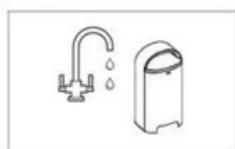
Toujours commencez le système rincé avec un réservoir d'eau potable. Videz la réserve d'eau, puis remplissez-la avec de l'eau potable fraîche et propre.
