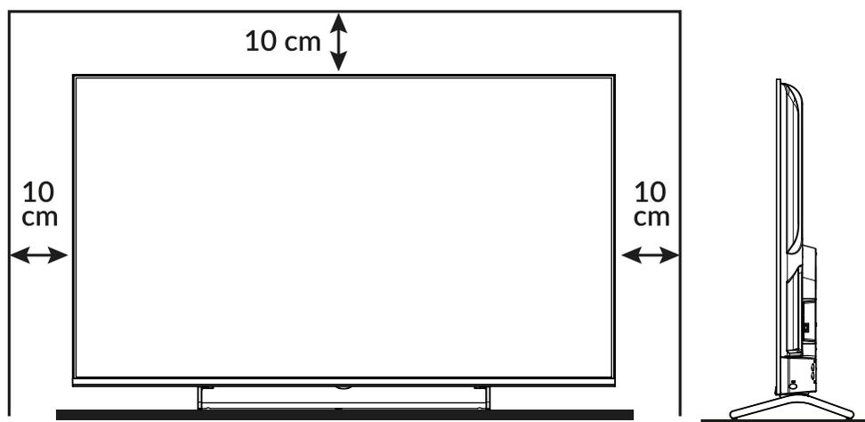
Installez l'écran sur une surface horizontale solide telle qu'une table ou un bureau. Pour la ventilation, laissez un espace libre d'au moins 10 cm tout autour de l'appareil. Pour éviter toute erreur ou situation dangereuse, ne placez pas d'objets sur l'appareil. Cet appareil peut être utilisé dans des climats tropicaux et/ou modérés.
