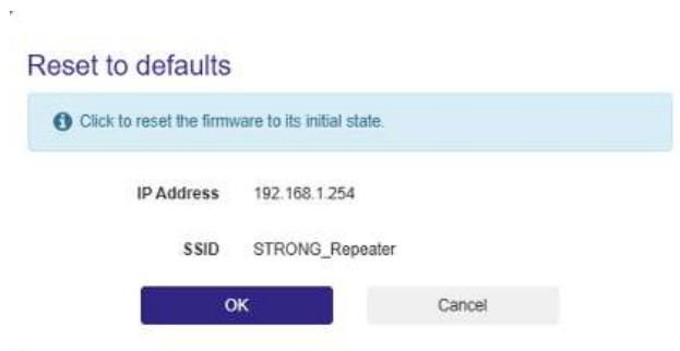
Kuva 55 — Lisäasetukset > Järjestelmä > Reset
