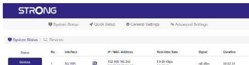
Kuva 24 — Järjestelmän tila > Laitteet — liitettyjen asiakkaiden luettelo
