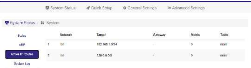
Fig. 36 — Stato del sistema > Sistema — rotte IP attive
