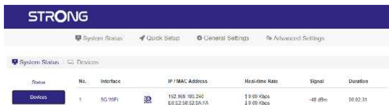
Rys. 24 — System Status > Devices — lista podłączonych klientów
