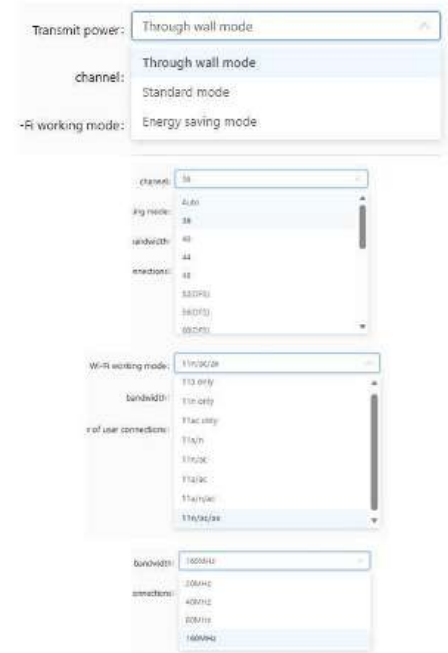
Abb. 22 — Netzwerk > 5-GHz-WLAN-Erweiterte Einstellungen und Dropdown-Optionen
