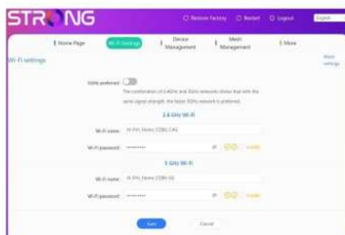
Εικ. 7 — Ρυθμίσεις Wi-Fi — προτίμηση 5GHz ΑΝΕΝΕΡΓΗ: διαχωρισμός 2.4 GHz και 5 GHz
