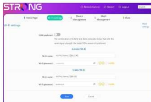
7. ábra — Wi-Fi beállítások — 5GHz előnyben részesítés KI: külön 2.4 GHz és 5 GHz
