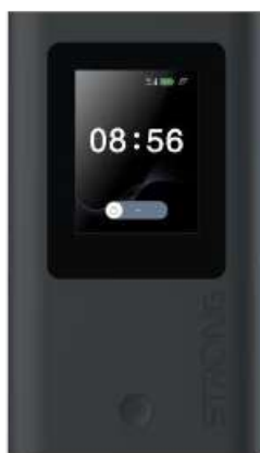
5GMIFIAX1800 — frontvisning: berøringsskjerm (øverst), av/på-knapp (nederst), STRONG-logo
