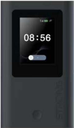
5GMIFIAX1800 — vista frontal: ecrã tátil (superior), botão de energia (inferior), logótipo STRONG
