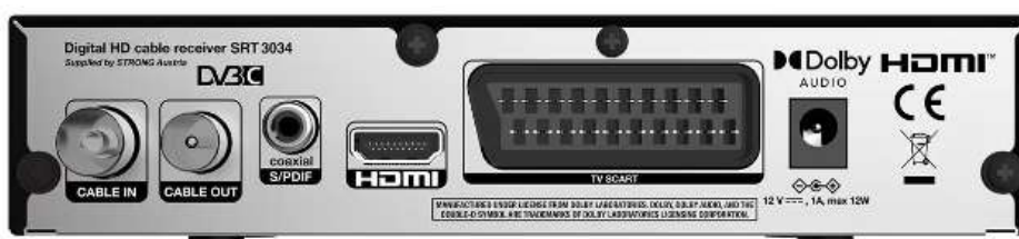
Obr. 3 — Prehľad produktu > Zadný panel
