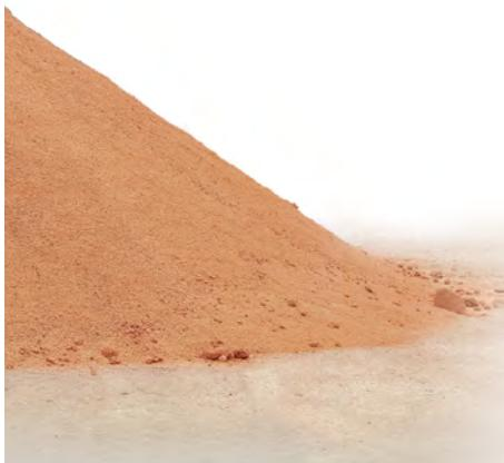
Le sable de briques est un sous-produit dérivé de la production de tuiles concassées.
