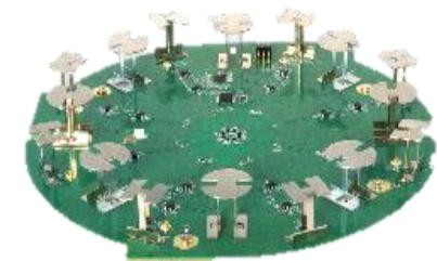
Patented 16-element BLE Antenna Array
