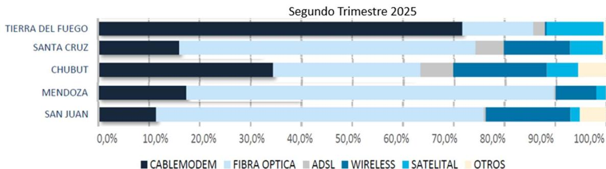
Destacamos que las tecnologías que impulsa SION corresponden a redes de acceso con tecnología de fibra óptica de tipo FTTx, donde x puede ser un Nodo (N) o un Hogar (H), de manera que cuando las redes son FTTN el acceso del cliente final se realiza mediante un cablemódem y cuando las redes son FTTH el acceso del cliente final se realiza mediante un modem de fibra óptica.
