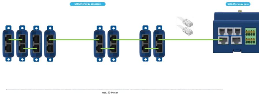
Der Anschluss der SMARTsens energysensoren erfolgt über Standard RJ45 Netzkabel AWG27. Es können bis zu 8 SMARTsens energysensoren an der SEB Anschlussdose angeschlossen werden. Die max. Distanz zwischen Anschluss SMARTsens energygate und letzter SMARTsens energysensor ist 20m.
