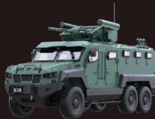
Машина вогневої підтримки з посиленням озброєнням – оснащена 30-мм туреллю
