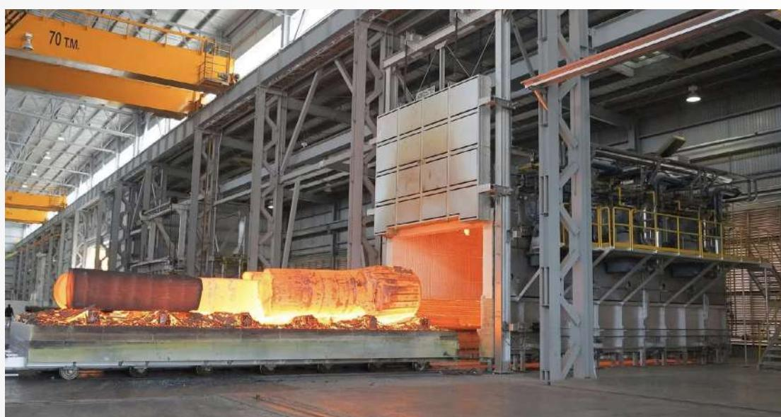
Fig. 1 NUTEC Bickley Horno Tipo Carro
