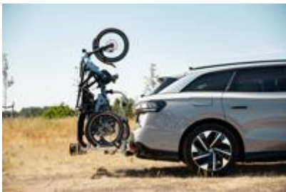
Bild 7: Zusammengeschoben passt das Kettwiesel TWO sogar auf PKW-Heckträger
