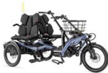
Bild 5: Drehbare Sitze erleichtern den Einstieg und den Transfer aus einem Rollstuhl
