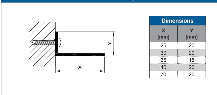
Vissez le clip de montage sur l'élément porteur, au cas où il serait collé, le fabricant décline toute responsabilité quant au décollage, aux dommages et aux éventuels dommages corporels qui en résulteront. Quantité recommandée jusqu'à 2,2 m - 2 clips par profilé, au dessus de 2,2 m - 3 clips et plus
