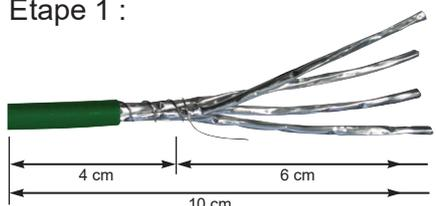
Dénuder 10 cm de gaine. Retirer le blindage général sur les 10 cm. Entourer le drain en torsade sur 4 cm. Retirer le feillard qui entoure chaque paire sur 6 cm.
