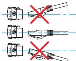
Insérer le cordon RJ45 parfaitement aligné dans l'axe du connecteur. Une mauvaise insertion risque d'endommager les broches.
