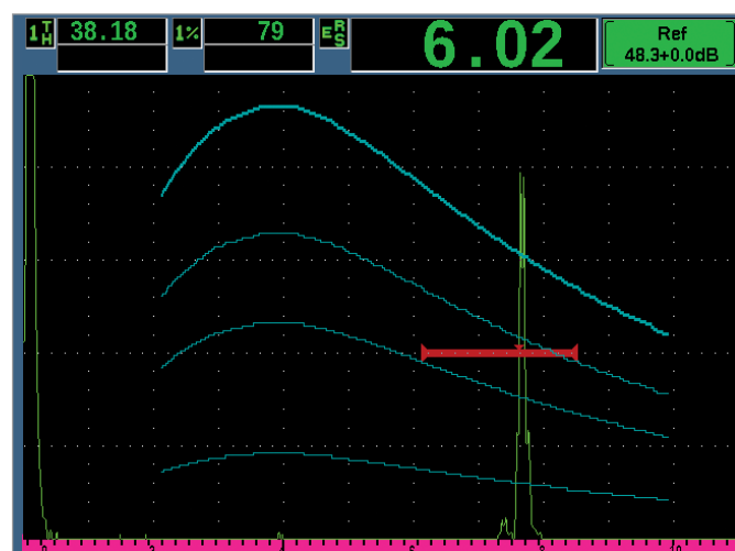
Funkcja DGS/AVG w EPOCH 650 - Tryb pełnego ekranu
