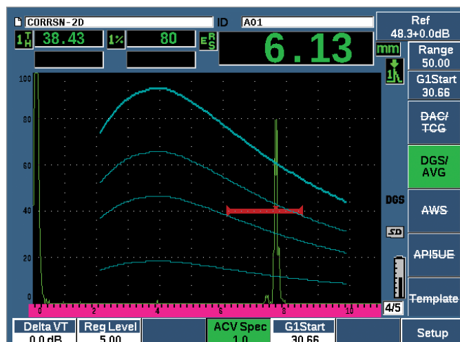
Funkcja DGS/AVG w EPOCH 650 -Standardowy tryb ekranu
