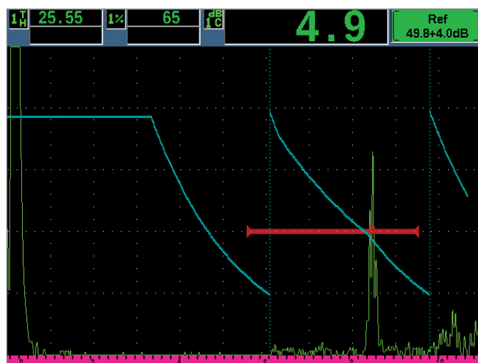
EPOCH 650 Funkcja Dynamicznych krzywych DAC/TCG
