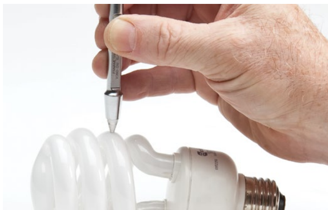
Opcja High Resolution pozwala na pomiar grubości z rozdzielczością do 0,001 mm (0,0001 cala).
