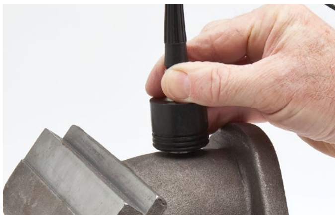
Pomiary wielu elementów odlanych lub materiałów tłumiących można wykonywać, korzystając z dostępnej w oprogramowaniu opcji High Penetration.
