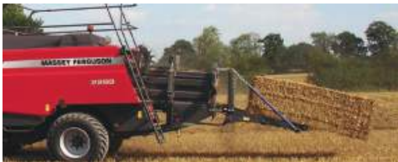
Zabudovaný systém vážení balíků zváží balík při výstupu z komory na válečkový žlab.
