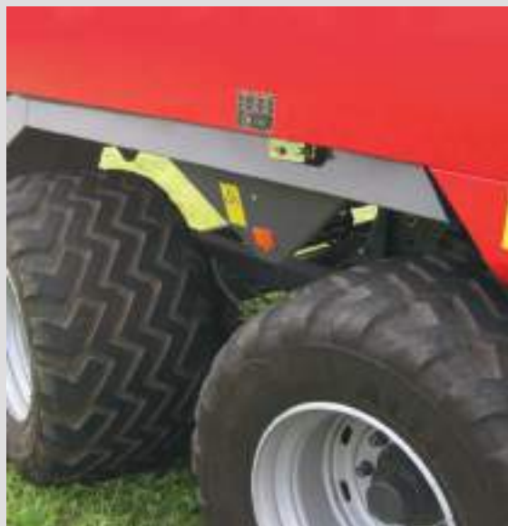
Volitelné radiální vysoko průchodné pneumatiky 620/40R22,5.*
