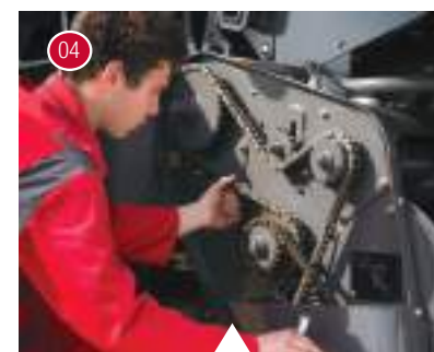
Kontrola napnutí řetězů pro sběrací ústrojí
