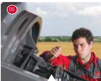
Seřízení spojky prokluzování setrvačníku.
