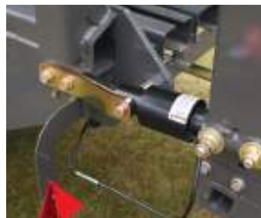
Snímače zatížení s vysokou přesností pro zabudovaný systém vážení balíku.
