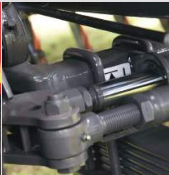
Hydraulická blokáce řízení zadní nápravy.
