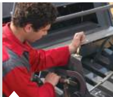
Jednoduché a spolehlivé nastavení délky balíku. Hvězdicové kolo pro délku balíku montované uprostřed lisovací komory se pohybuje s horními dvířky komory, což zaručuje pevnou trakci hvězdicového kola ve všech podmínkách sklizně a zlepšuje přesnost délky balíků.
