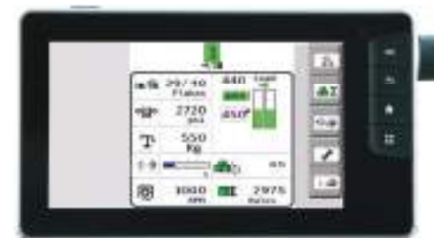
Automatická regulace hustoty pomocí terminálu lisu FieldStar 5.
