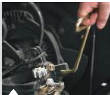
Každou hlavici uzlovače lze zvednout za účelem kontroly a servisu.
