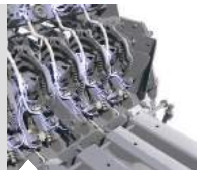
System AutoLube snižuje údržbu a zvyšuje spolehlivost uzlovače.
