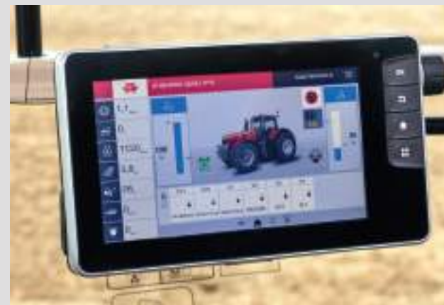
Řízení lisu pomocí terminálu ISOBUS traktoru
