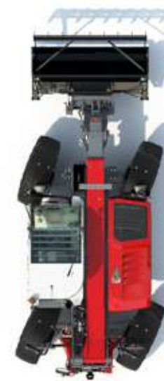
REŽIM řízení kraba – pro účelné plnění a nivelování a práci podél stěn ve stísněných prostorech.
