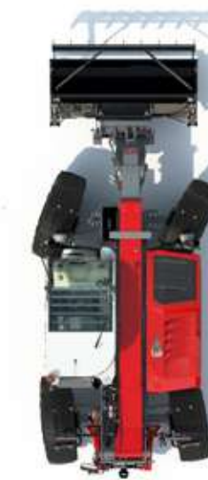
ČÁSTEČNÝ REŽIM kraba nastaví úhel zadních kol – vhodné pro práce například při silážování nebo čištění stodoly.
